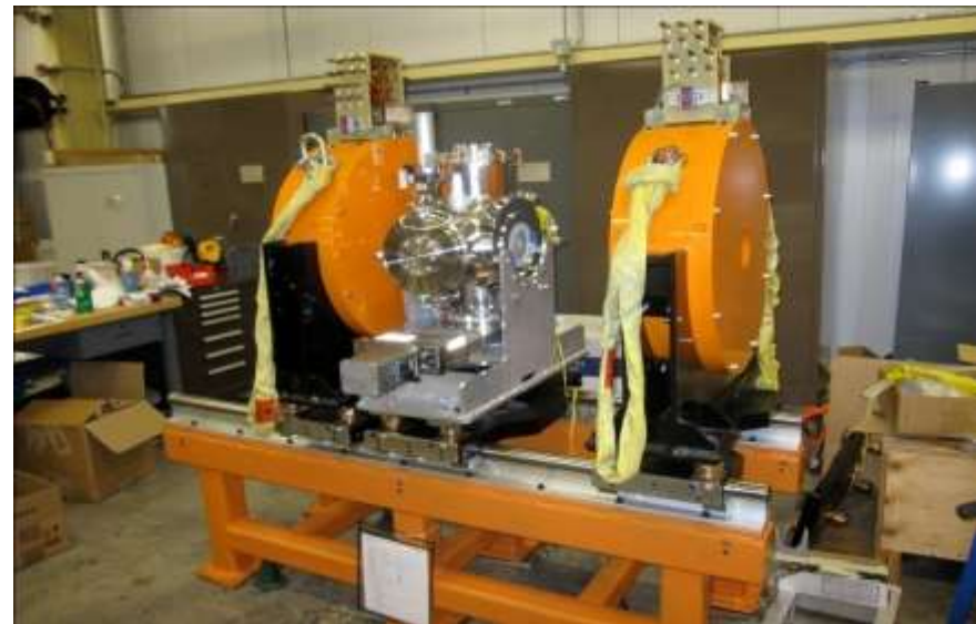
Magnetic LEBT under Assembly on Test Stand
